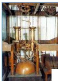
Рисунок 5. Паровая машина И.И.Ползунова
