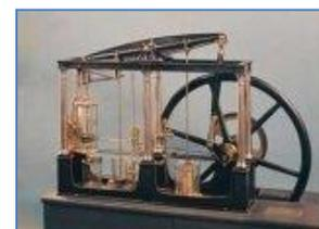
Рисунок 6. Паровая машина Уатта
